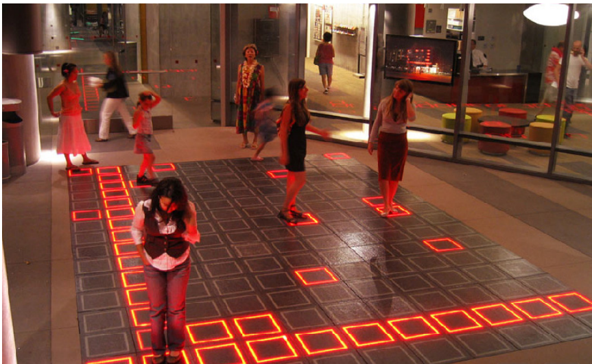
Vue intérieure du hall : Le tapis est composé de lumières LED dotées de capteurs qui détectent la présence des visiteurs et affichent des motifs lumineux interactifs en réponse. Sur la façade du bâtiment s'affichent simultanément à la ville les mêmes motifs lumineux qui sont sur le tapis interactif. L'intelligence de l'environnement et de la surveillance humaine sont combinés avec une sensibilité de jeux vidéo, la circulation des piétons dans le bâtiment contrôle l'éclairage sur sa façade.
